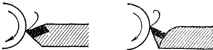
Рис. 475. Обработка металлического вала резцом, армированным пластинкой из сверхтвердого сплава (показана черным)
