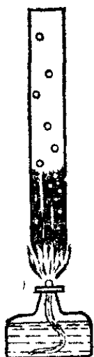
Рис. 433. Получение активированного угля
