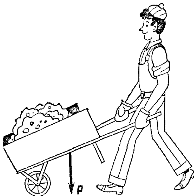
Рис. 139. Тачка как рычаг
