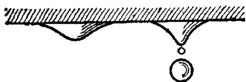
Рис. 372. Повисшая капля воды удерживается от падения силами сцепления. Слишком тяжелая капля падает
