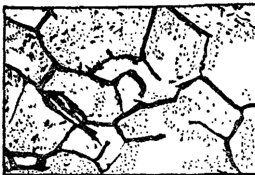
Рис. 456. Шлиф поверхности алюминия. Черные тонкие линии — следы прослоек между кристалликами
