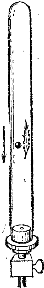
Рис. 75. В трубке, из которой выкачан воздух, перышко падает так же быстро, как дробинка
